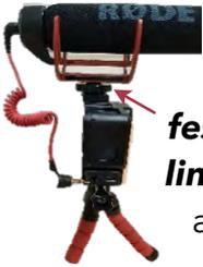
Das **Mikrofon** wird oben auf dem Gehäuse befestigt. Es muss dafür **in** die **Schiene geschoben** und mit dem **Rädchen festgeschraubt** werden. Das **Kabel** wird auf der **linken Seite in den Adapter** gesteckt und ist somit auch einsatzbereit.
