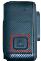
Bevor Sie jedoch eine Aufnahme starten können, muss eine **Micro-SD-Karte** eingelegt werden. Der Kartensteckplatz befindet sich unter der Abdeckung auf der Unterseite.
