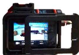
Um das Gerät aus der Halterung zu entfernen, muss auf der linken Seite die **Sicherung** (rote Markierung) leicht eingedrückt werden. Danach lässt sich die Abdeckung zur Seite schieben und das Gerät aus dem Gehäuse entfernen.
