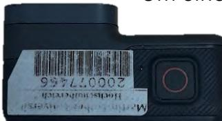
Um eine Aufnahme zu starten, muss die [○] **Aufnahmetaste** auf der oberen Seite des Gerätes betätigt werden. Zum Stoppen muss dieselbe Taste ein zweites Mal gedrückt werden.
